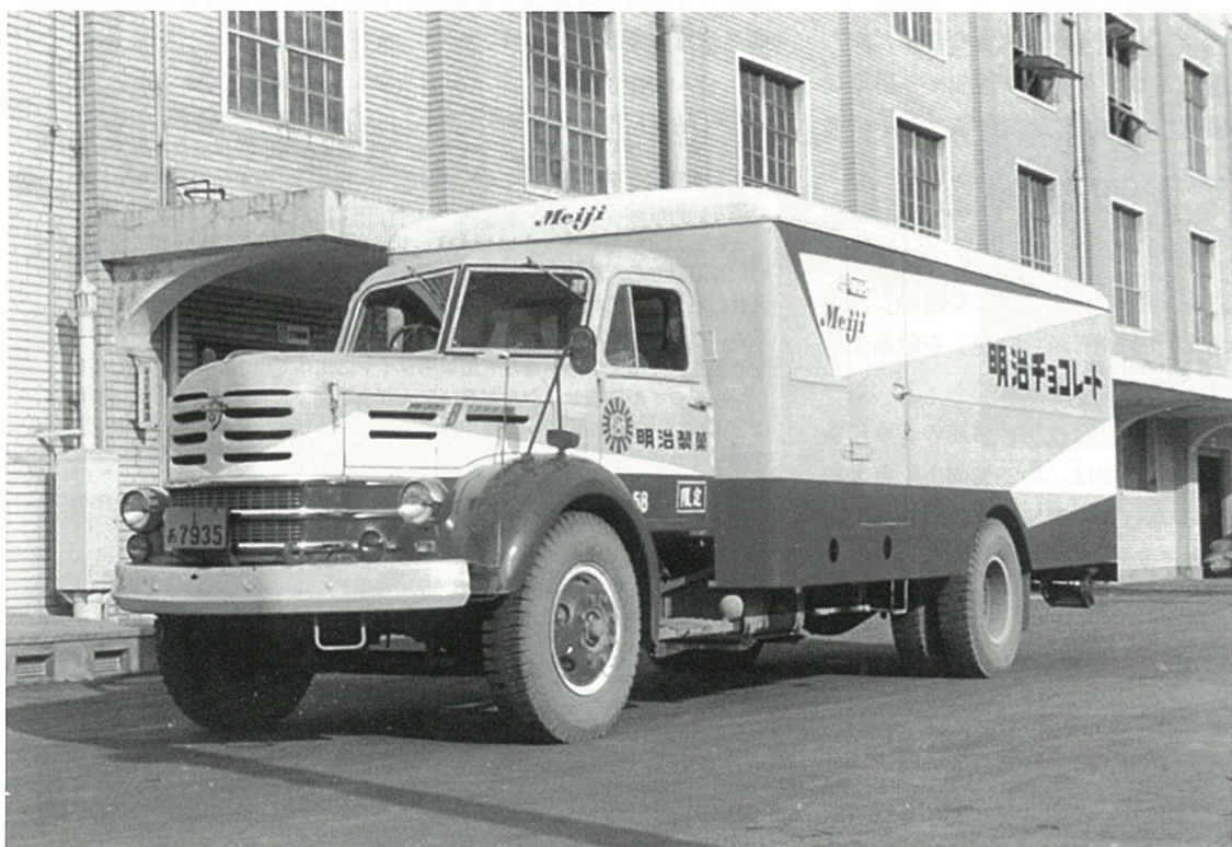
↑復元されたボンネットトラック。ベースとなったのは4灯式ヘッドランプを持つ1969年式のTD50(本誌No24参照)というが、ボンネットとキャブはその1世代前のスタイルに変更された。保冷車ボデーも新製された(本項の写真:川崎陸送)
